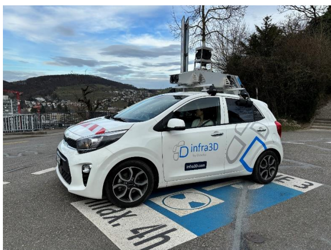
Eingesetztes Fahrzeug der Firma iNovitas zur digitalen Vermessung
